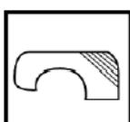
Limpar adequadamente a superfície a ser pintada, removendo partes soltas, ferrugem, oleosidades e resíduos impregnantes, com Solução Desoleante 400. Aplicar washprimer para proteger as áreas expostas onde a chapa foi atingida.
